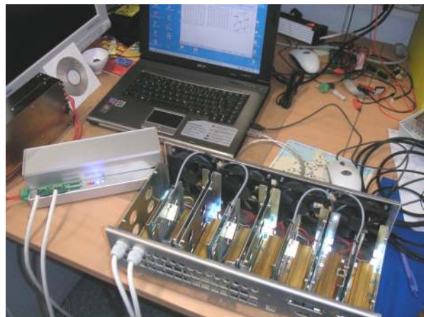
Prüfumgebung mit PC, Netzteil und Lastwiderständen
